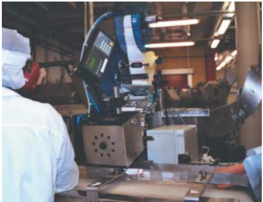
Las etiquetas se colocan mediante un aplicador de soplado que las adhiere a los productos con una gran precisión a medida que éstos avanzan con rapidez en la cinta transportadora.
